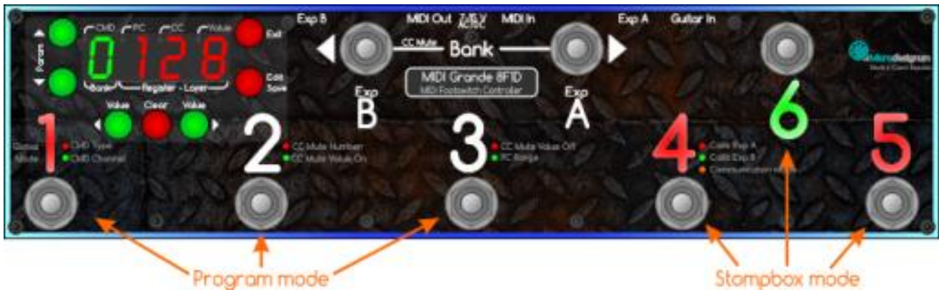
図: プログラムとレジスタのストップボックスモードのグローバル設定の例。
